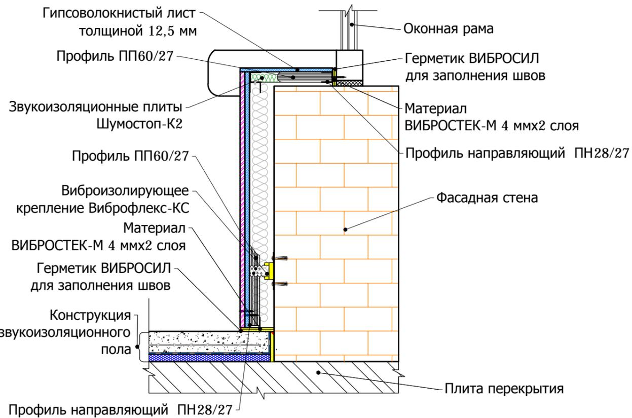
**Схема дополнительной звукоизоляции оконных откосов.
